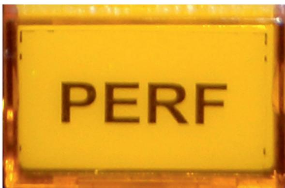
An der Front der Luftpolstermaschine wird mit einem einzigen Druck auf die Taste «PERF» zwischen Einzelkissen und Luftpolsterketten umgeschaltet.
